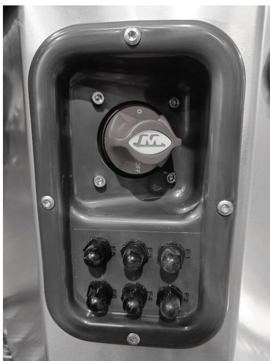
Kuva 6. Brytartavlans och säkringarnas placeringar
