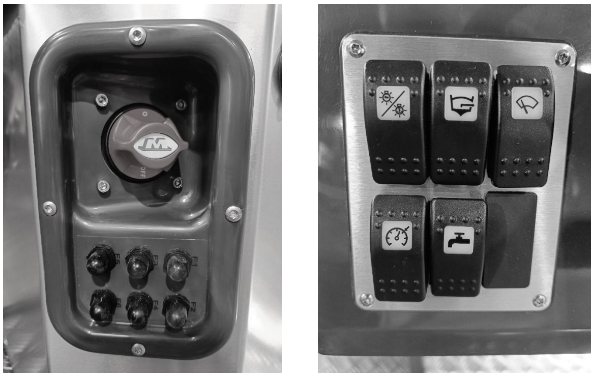
Kuva 6. Brytartavlans och säkringarnas placeringar
