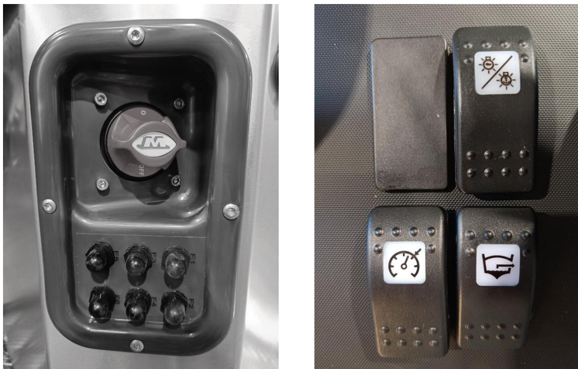
Bild 6. Brytartavlans och säkringarnas placeringar
